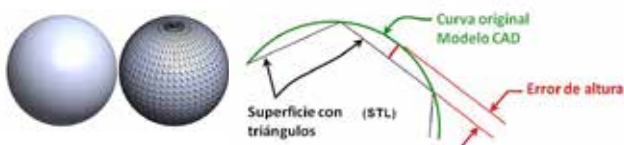
Figura 1.- Modelo CAD, fichero STL y error generado en un STL respecto a modelos CAD.
