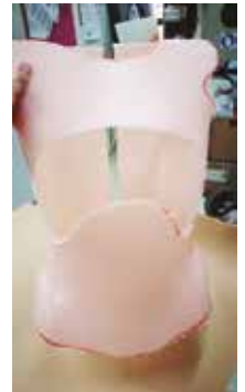
3. Moldeo del material termoplástico
